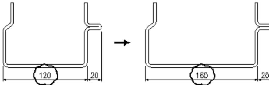
修改以后，其惯性矩  $I$  由原来的  $30148 \times 10^6 \text{ mm}^4$  变成  $6.426 \times 10^6 \text{ mm}^4$ ，截面模
